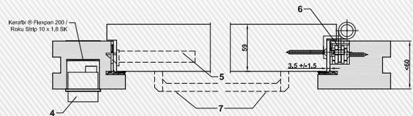
Horizontalschnitt CombiModul Blockrahmen
