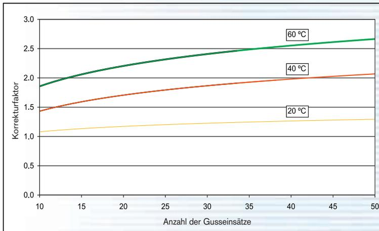
Die endgültige Durchbiegung  $u_{fin}$  bei Winterbetonierung ist erhältlich aus der Formel  $u_{fin} = u \cdot k_{temp, corr}$ , in der  $u$  die Durchbiegung gemäß Tabelle 4-39 bis 4-48 ist.
