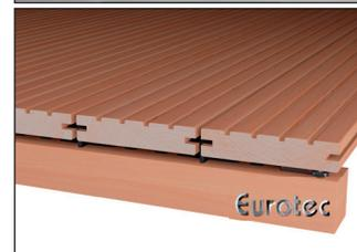
Ausrichten und Fixieren der nächsten Dielen, mit dem **T-Stick** die Verschraubung vornehmen bis alle Dielen befestigt sind.
