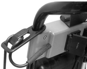
Platzieren Sie das Netz-kabel in die Kabelzugentlastung.
