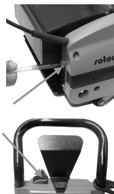
Verwenden Sie das Gerät nur für die am Leistungsschild angegebene Spannung. Bei Überbelastung des Motors schaltet der Schutzschalter aus und unterbricht die Stromzufuhr. Nach ca. 30 Sekunden kann der Knopf unter dem Kabeleintritt eingedrückt werden. Damit ist die Maschine wieder funktionsbereit.
