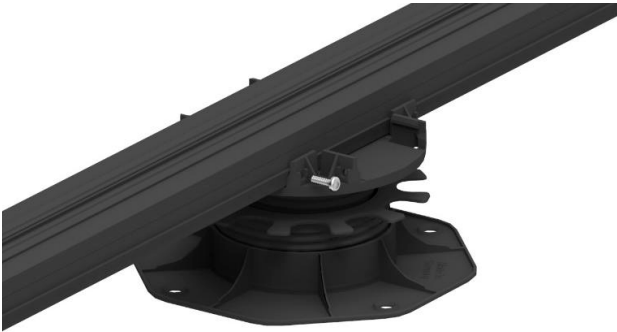
Bild 7. Die Aluminiumunterkonstruktion wird auf das Terrassenlager so weit aufgedrückt, bis das Terrassenlager eingerastet ist. Danach sollten alle Terrassenlager mit je 1 Bohrschraube 3,9 x 25 an der Unterkonstruktion fixiert werden.
