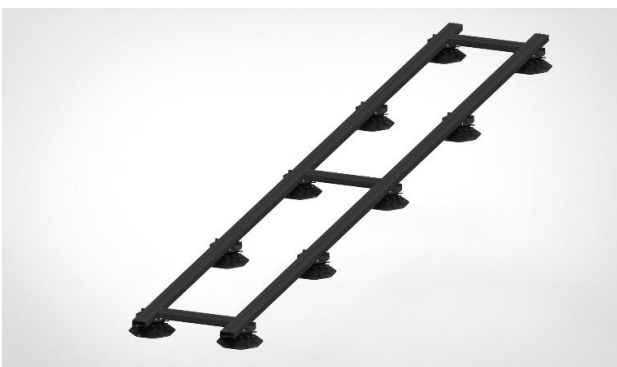
Bild 11. Im ersten Feld sollten 3 Querstücke eingebaut werden. Alle Querstücke sind mit den Terrassenlagern zu verschrauben.
