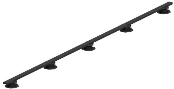
Bild 8. Die Terrassenlager müssen mit einem maximalen Achsabstand von 970 mm an die Isostep Twixt Aluminiumunterkonstruktionen geschraubt werden.
