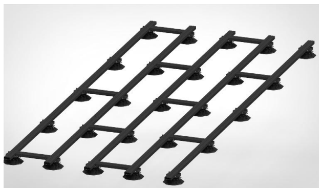
Bild 12. Die Querstücke sollten versetzt in den nächsten Feldern montiert werden, so dass eine ausgesteifte Konstruktion entsteht. Mindestens 2 Querstücke je Feld sind erforderlich.
