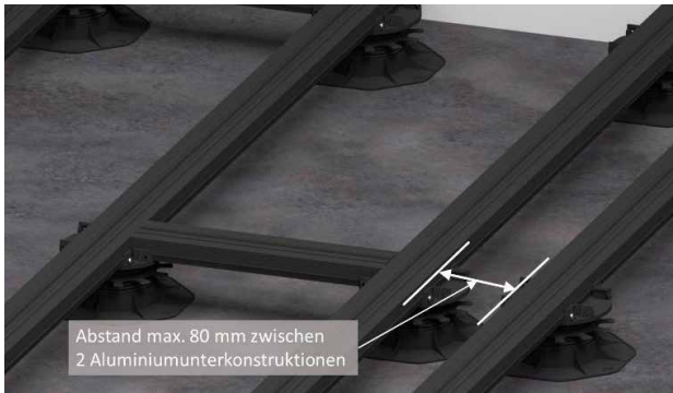
Bild 13. An Längenstößen der WPC-Dielen müssen immer 2 Unterkonstruktionen mit einem maximalen Abstand zueinander von max. 80 mm eingebaut werden.
