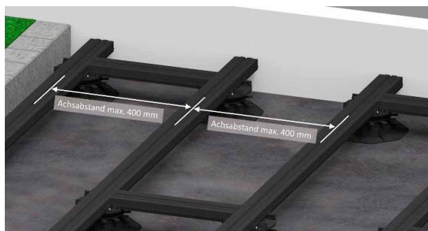
Bild 3. Der Achsabstand der Unterkonstruktionen darf 400 mm nicht überschreiten.
