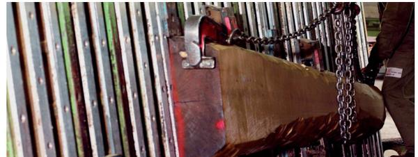
**5 Sofortiges Trocknen im Presstrockner auf eine Restfeuchtigkeit von ca. 8 – 10%.**
