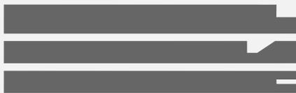
Postforming-Paneele: Verfahren, bei dem der Kante ihre Form gegeben und diese dann mit derselben Dekorbeschichtung umhüllt wird wie die Plattenoberflächen.
