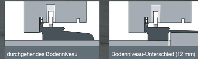
Bodenabsenkndichtung bei allen Haustüren Standard!
