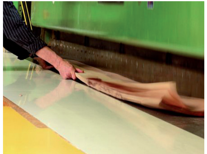
6. Paralleles Besäumen der Furniere auf der Frasierstrasse.
