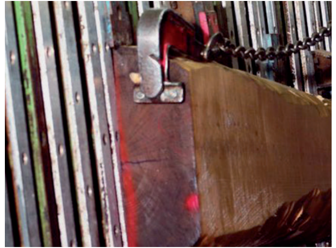
4. Einspannen des Stammteiles auf dem Flichtisch, welcher den Stamm gegen das Messer führt.
