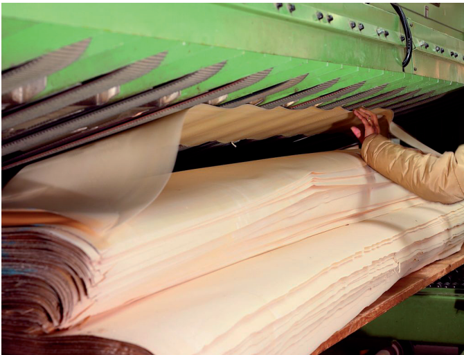
5. Sofortiges Trocknen im Presstrockner auf eine Restfeuchtigkeit von ca. 8 – 10 %.
