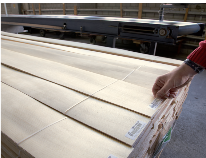
7. Elektronisches Vermessen der besäumten Furniere.
