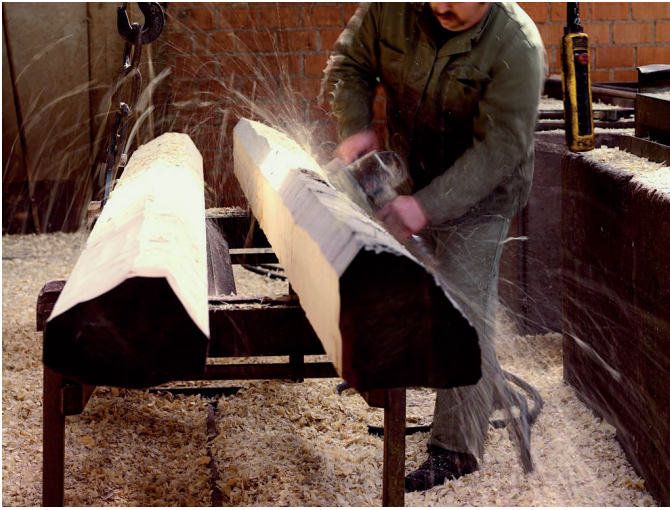
3. Entfernen der restlichen Rinde vor der Messerung.
