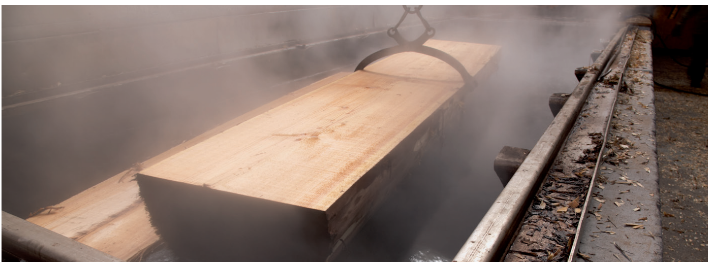
2. Kochen und Dämpfen des Stammes vor der Messerung in Chromstahlgruben.
