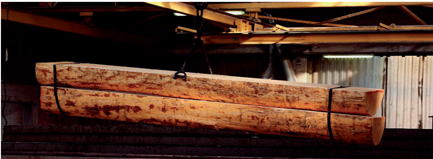
1. Eintreffen der Stämme im Furnierwerk. Auftrennen in der Länge und Zusammenbinden mit Stahlband.
